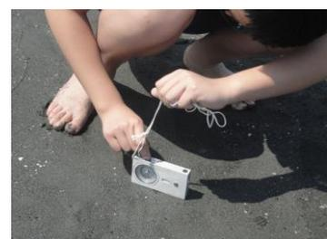
以傾斜儀實測沙灘坡度
