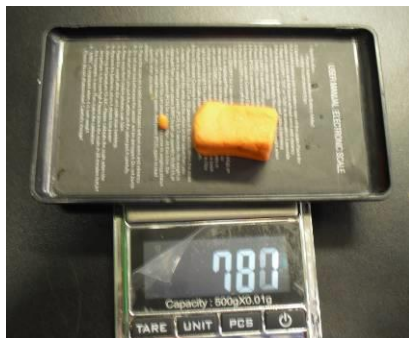
圖三：製作模擬防砂壩方形鼎塊的用具
