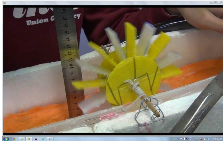
圖二十二：水車固定在上游位置測量使用 2 個馬達的水流速度與水位
