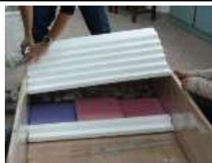
圖 32：以保麗龍板鋪設階面，但加水後，階面承受不住水的浮力，漂起來了。
