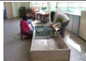
圖 33：改以厚重的大理石板當階面，鋪上海沙後，完成實驗槽設計。
