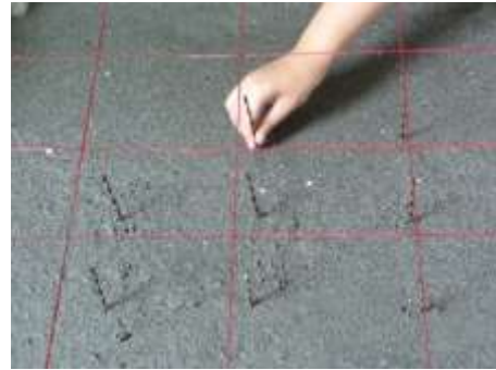
圖 36：在各標記點，插入用竹籤製作的標尺。我們在標尺上畫出黑白相間隔的刻度，用來標示海浪對沙灘的侵蝕量。
