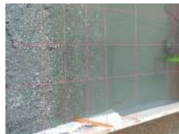
圖 34：在經濟部水利署 101 年的研究總報告書中指出，化仁海岸的坡度約為 5 度。因此我們設計的實驗槽是以 60x30x2cm 的大理石板鋪設灘面台階，第一階為 14cm，第二階為 12cm，第三階 8cm，這樣的鋪設方式可形成底為 60cm 高 6cm 的直角三角形，經三角函數計算可求得實驗槽灘面坡度為 5 度。
