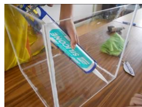
圖 6-11 老闆協助切壓克力板 圖 6-12 以氣仿黏合壓克力板 圖 6-13 使用矽利康固定箱子 圖 6-14 固定輪子於底面上
