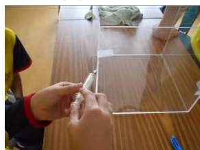
圖 6-11 老闆協助切壓克力板 圖 6-12 以氣仿黏合壓克力板 圖 6-13 使用矽利康固定箱子 圖 6-14 固定輪子於底面上
