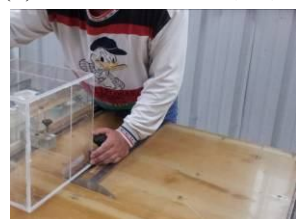
圖 6-11 老闆協助切壓克力板 圖 6-12 以氣仿黏合壓克力板 圖 6-13 使用矽利康固定箱子 圖 6-14 固定輪子於底面上
