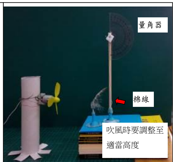
圖 9 羽毛防風測試架
