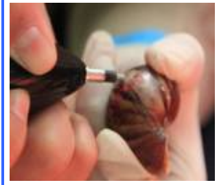
圖 9：電子雕刻筆鑽洞
