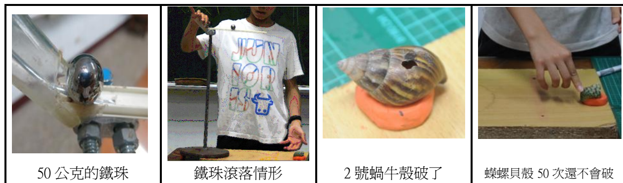
圖 5-9 蝸牛殼與海生貝殼耐撞實驗過程
