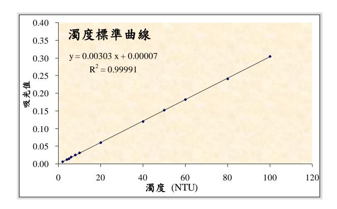
如上圖所示,將吸光值與濁度作回歸,得到的方程式為 y=0.00303x+0.00007, y 代表分光光度計所測的吸光值,x 代表濁度。若今測得一試水的吸光值為 0.00007,計算後得到 x=0,也就是說濁度值為 0 NTU。因此將本實驗所測得的試水吸光值帶入方程式中,計算後即可得到相對應的濁度值。
