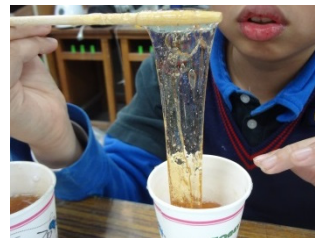
圖 22：我們發現沙土鼻涕蟲加硼砂水攪拌，硼砂水會消失，鼻涕蟲會變軟
