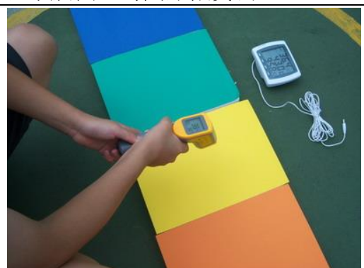
圖五：使用紅外線溫度計實測不同顏色紙張表面溫度
