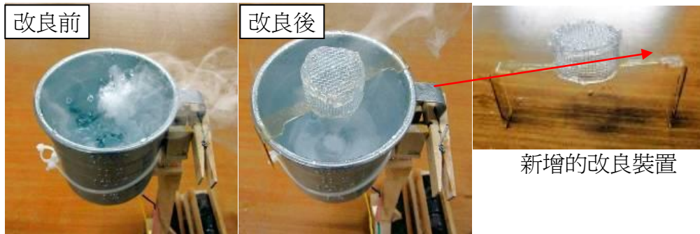
圖二十五 經改良加裝一個裝置後，就不再噴出水了
