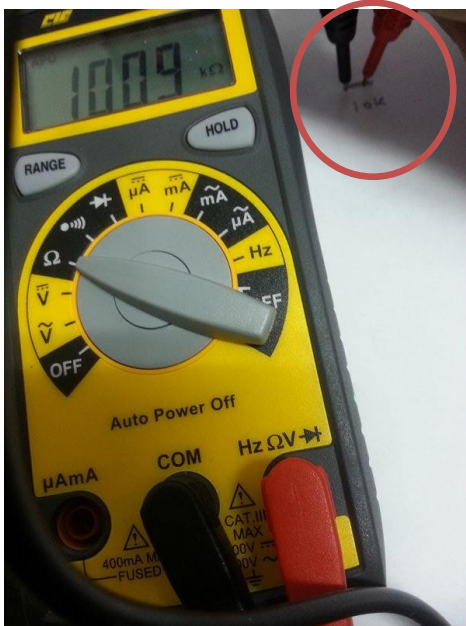
圖 4-8-1 自製石墨線電阻圖一
