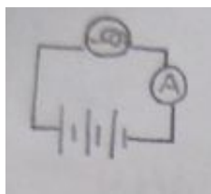
圖 4-5-1 一顆燈泡串聯三個電池圖
