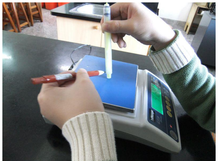
圖 4-1-4 壓力筆壓力測試實驗操作圖
