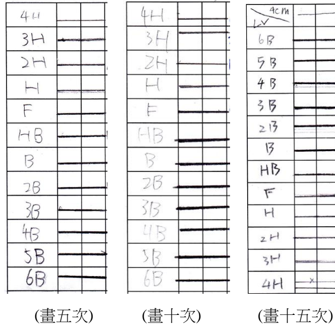
圖 4-2-1 不同鉛筆硬度比較繪製圖
