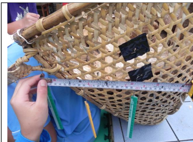
空背篋重心較低，離支點距離較長。
