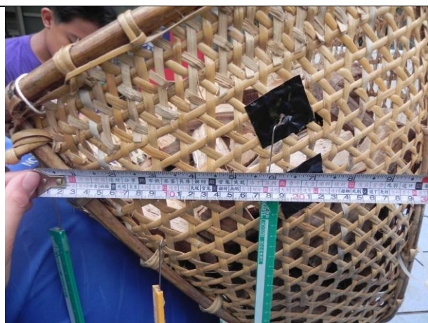
裝滿的背篋重心較高，離支點距離較短。
