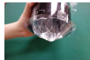
圖 9-3：塑膠水盆下面透明塑膠片曲度為「凸」時。
