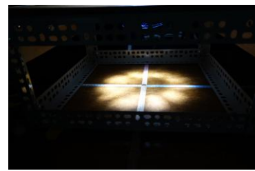
圖 9-9：水盆下面曲度為「凹」時，亮度較分散。
