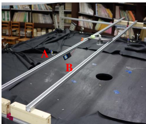
圖 2-4：實驗屋上方角鐵鎖 2 支鋁製凹槽，兩鋁製凹槽間以木塊固定另 2 支鋁製凹槽 AB，移動木塊可讓燈源進行南北向調整。
