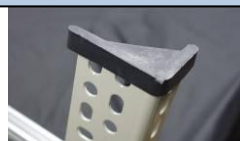
圖 2-7：角鐵末端套上塑膠保護套。
