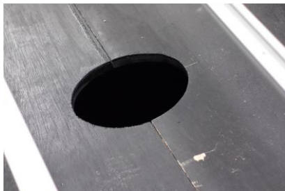
圖 2-3：實驗屋上方黑色木板正中心鑿一個直徑 12.5cm 圓洞，以便更換不同的寶特瓶。
