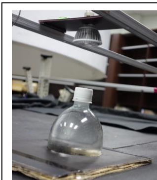
←圖 3-3：每種寶特瓶的瓶身直徑不盡相同，因此會先將瓶身嵌入紙箱瓦楞板中，再置於實驗屋木板圓洞上實驗。
