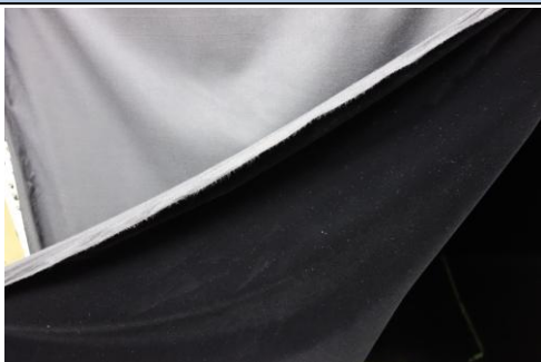
圖 2-6：四周懸掛黑色絨布，以防止屋外光線的干擾，以及避免屋內光線在布上的反射情形。
