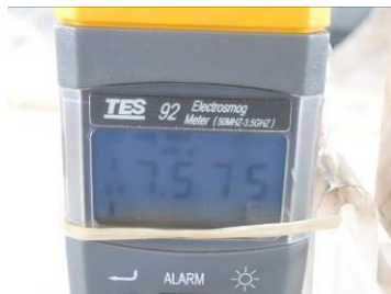
圖 6-24 將電磁波偵測儀調成 max 模式
