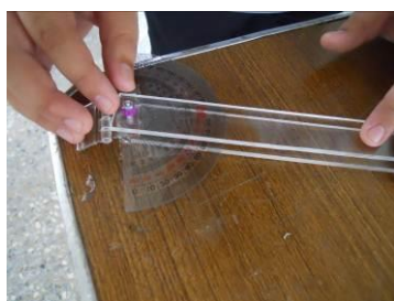
圖 6-9 以螺絲結合各部位零件
