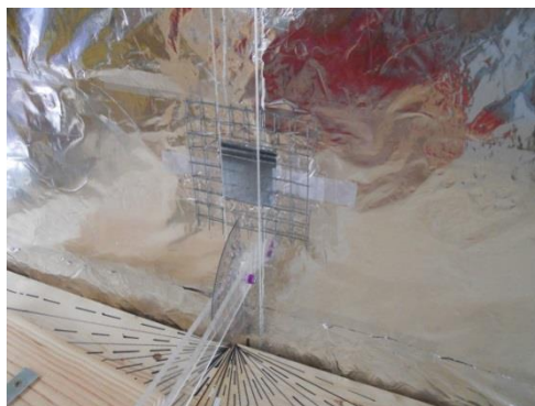
圖 7-3 在正方形孔洞前放置交錯鐵網
