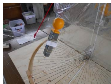
圖 6-10 固定電磁波偵測儀
