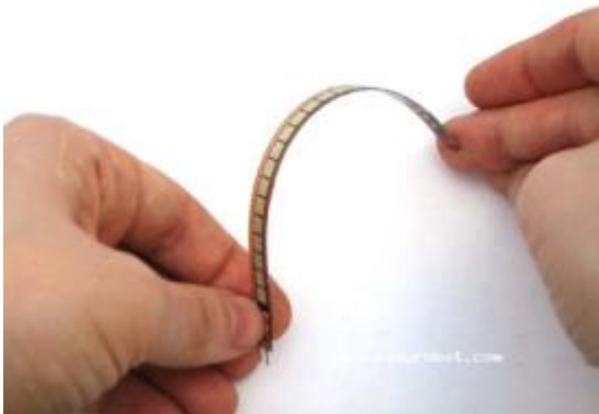
(圖十五) 彎曲率感知器使用方法
