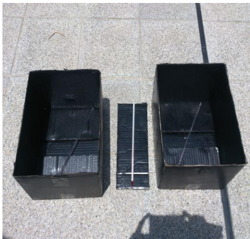
圖一、玻璃和壓克力效能比較裝置
