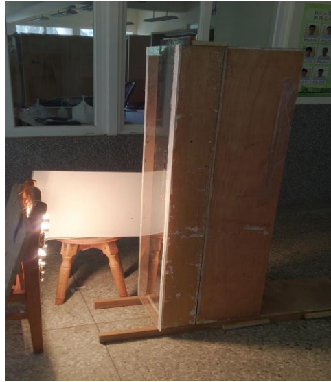
圖二十一、鹵素燈取代太陽實驗照片
