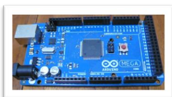
圖九 Arduino Mega 2560 微控制器
