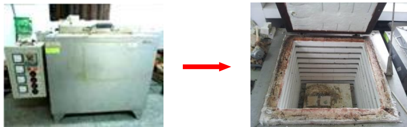
圖 4-8 鐵質磁磚之窯燒
