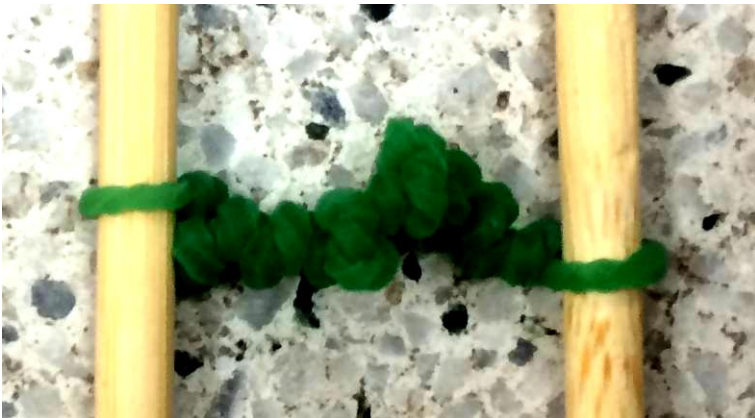
▲圖 8 橡皮筋雙攪後內部產生極大的扭力，足以讓其自身形變，進而增加橡皮筋與毛髮的接觸面積，提升摩擦力。
