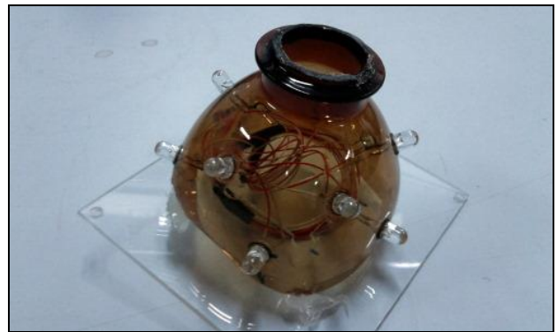
圖 5-2 小組設計的圓罩多點發射頭組
