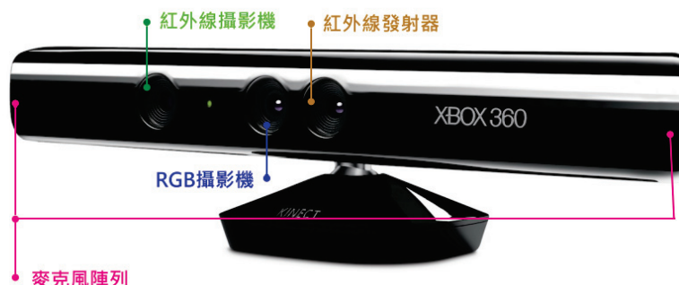
圖 11 Microsoft Kinect 硬體結構
