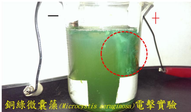
圖十六：銅綠微囊藻 ( M. aeruginosa )及校園生態池水體經過連續三小時電擊，於正極處匯集成一團
