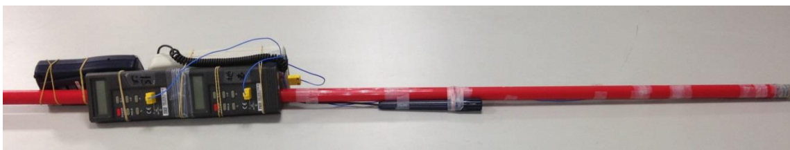
自行設計量測不同高度之溫度的實驗裝置
