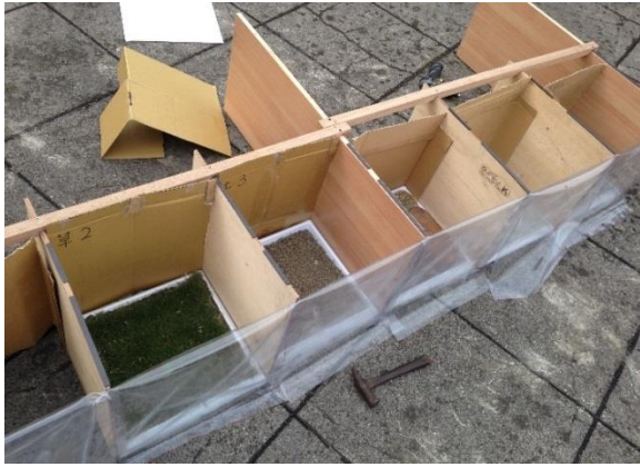
實驗架設。左側為初步試驗，以木板作為氣流阻隔之裝置；右側為改良後裝置，加強透光與氣流阻隔設計，減少水平方向空氣流動混合。
