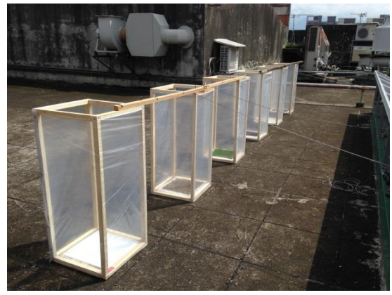
實驗架設。左側為初步試驗，以木板作為氣流阻隔之裝置；右側為改良後裝置，加強透光與氣流阻隔設計，減少水平方向空氣流動混合。
