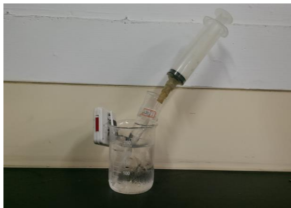
▲圖十一 將待測氣體通入試劑
