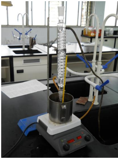
▲圖二十二 攪拌的回流裝置
