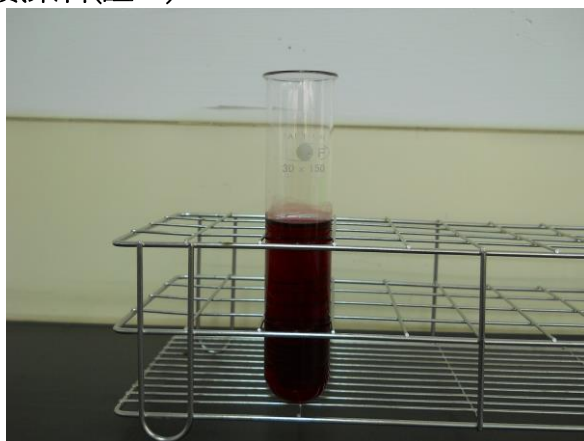
▲圖四 吸收二氧化氮後的試劑
