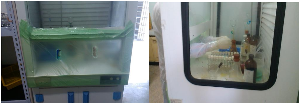
圖二：自製簡易的乾燥箱(dry box)
