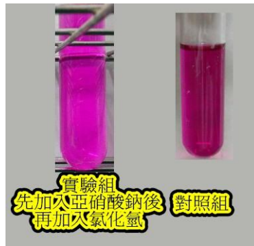
圖七：Griess Reagent 與亞硝酸鈉反應後加入鹽酸與對照組的比較
