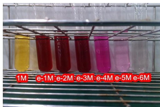
圖十：Griess reagent 分別加入不同濃度( 1\text{M}\sim 10^{-6} )的 \text{NaNO}_2(\text{aq})
