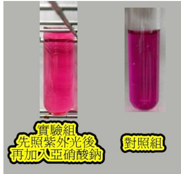
圖六：Griess Reagent 照紫外光後再加入亞硝酸鈉後與對照組的比較(30 分鐘)
