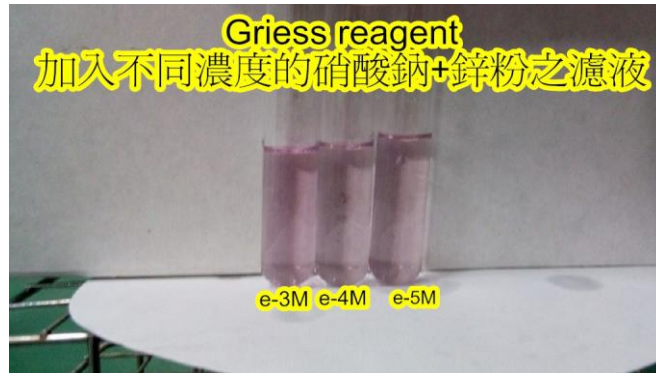
圖十一：Griess reagent 加入不同濃度的硝酸鈉+鋅粉
