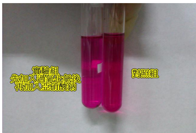
圖四：Griess reagent 先加入過氧化氫後再加入 \text{NaNO}_2(\text{aq}) 反應後與對照組比較
