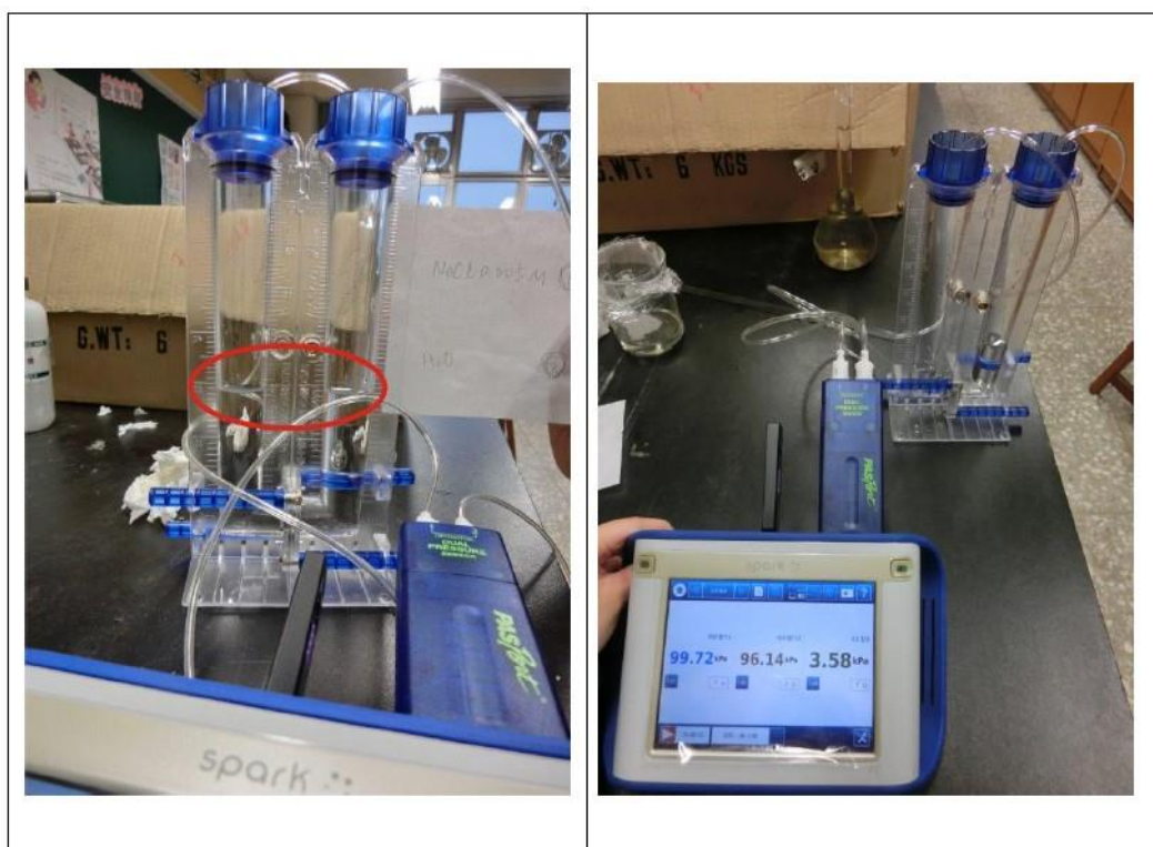
圖 9、以 Spark 滲透壓測量模組測量滲透速率之實驗裝置圖。
