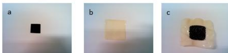
圖 3 (a)碳紙(b)質子交換膜(Nafion)(c)觸媒層固定於質子交換膜
