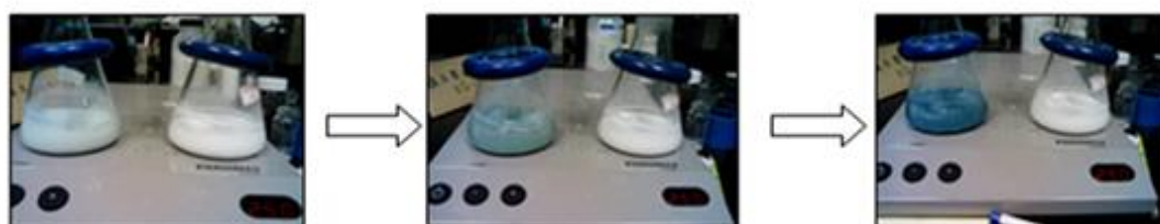
圖 8 PEDOT 形成於 TiO 2 的反應過程示意圖
