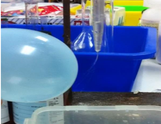
圖 6-1 正己烷受帶電氣球吸引的偏折情形
