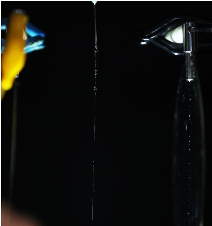
圖 6-4 管口與兩電板離相同距離
