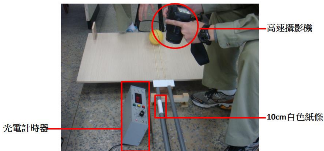
圖(七)實際測量初速時的照片
