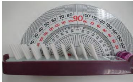
(圖二十)調整梳子角度成70°角
