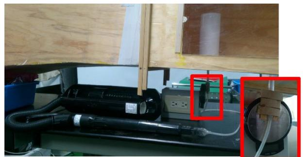
圖二十八、強制抽氣裝置：細管和抽氣裝置連接，經由抽氣裝置將圓柱周圍的空氣層吸出，並利用電子秤測出阻力
