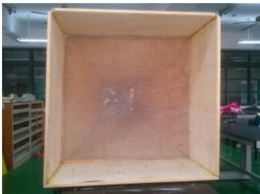
圖二、風洞前視圖(內含兩層蜂巢網，外層網眼為 2×2mm，內層網眼為 1.5×1.5mm，吸入流體產生細微的亂流後再變為層流)
