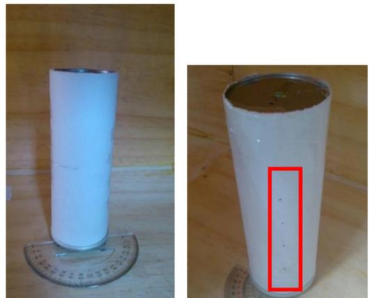
圖四、風洞內置圓柱附有四個小孔, 方框為小孔位置, 量角器指示小孔旋轉角度
