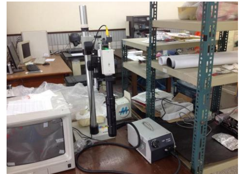
圖 2-2 單筒顯微鏡以及 CCD
