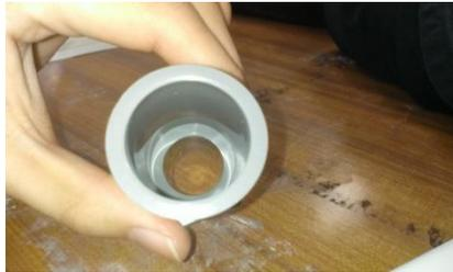
圖：轉接管，有改變截面積的情形
