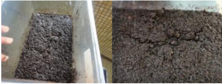
(圖二十八)土壤液化情況。右上、左上為加水前、加水後 右下、左下為土壤液化前產生的裂痕
