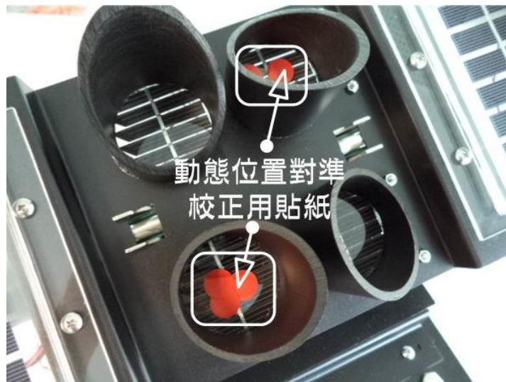
圖 40、動態位置對準校正的方法(遮光用的紅色圓點貼紙)
