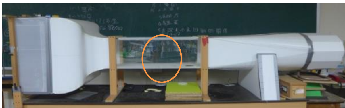
圖六、利用風洞探討不同葉脈與風的關係，將待測物放置測試段(圈選處)
