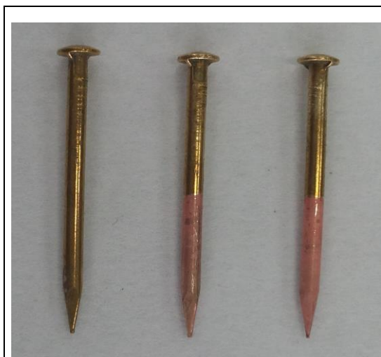
圖三十一：取自【實驗五－2】正常銅釘，標準電鍍液、佳化電鍍液電鍍成品
