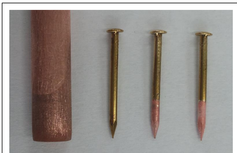
圖三十五：相使用教科書電鍍裝置（標準電鍍液）的紅銅鍍層，原始銅釘，實用型粉筆筆電鍍裝置（標準電鍍液）的紅銅鍍層，實用型粉筆筆電鍍裝置（佳化電鍍液）的紅銅鍍層。
