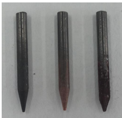
圖八：取自【實驗二—2】—正常碳筆、鍍上紅銅情況、被氧化銅汙染的情況。
