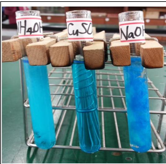
圖二十八：取自【實驗五－1】，氨水、氫氧化鈉都與銅離子反應生成氫氧化銅
