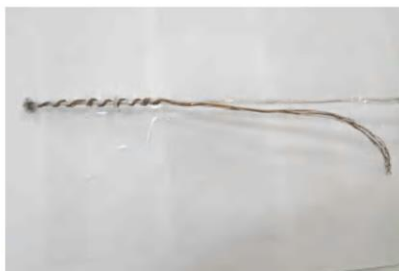
8 鐵絲纏繞膠帶當銅線支撐桿纏繞緊密螺旋的銅線為正極
