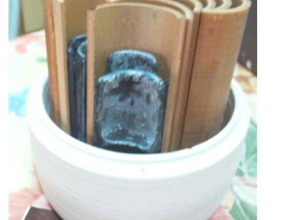
1200℃乾餾桂竹前後的長度變化 量測最多的減少為 25%，相當於體 積最多減少為約 0.75^3 =不到五成
