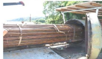
以熱蒸氣蒸餾 180°C 炭化後的桂竹
