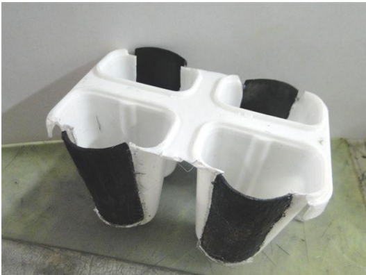
半片桂竹炭化後的電極直接設計組裝在冰盒上
