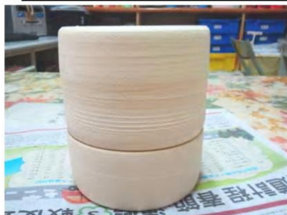
桂竹二次乾餾密封陶罐製作成品
