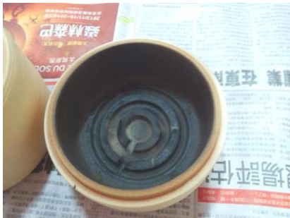
桂竹二次乾餾密封陶罐內部同心圓形凸紋及溝槽設計
