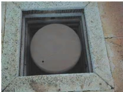
桂竹二次乾餾密封陶罐設計尺寸 恰好可置入小型電窯中
