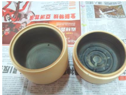
桂竹二次乾餾密封陶罐內部同心圓形凸紋及溝槽設計
