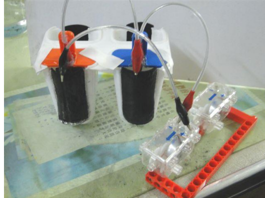
自製的第二代廢鋁空氣電池
