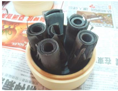
1000℃乾餾後表面竹膜剝落及氧化
