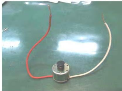
1 將報廢倒帶機的馬達拆下並以焊錫焊接兩條導線
