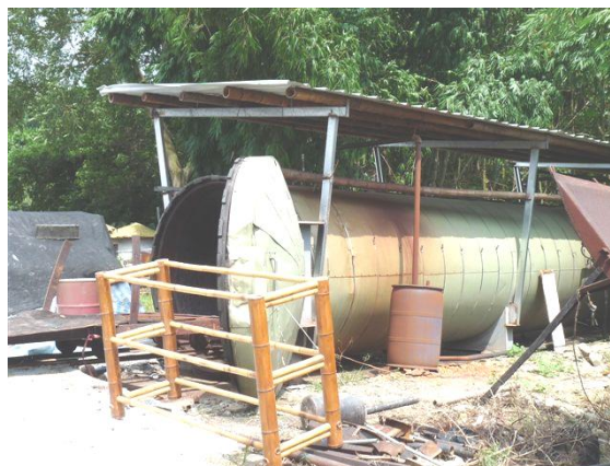
桂竹初級蒸餾炭化竹大型裝置
