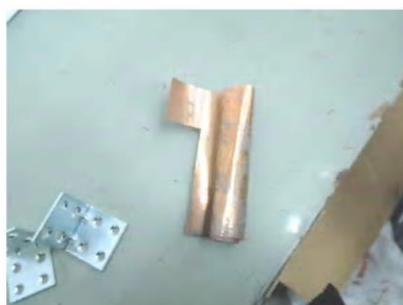
10 銅箔捲成筒狀後留一小段突出物為炭化桂竹的電刷
