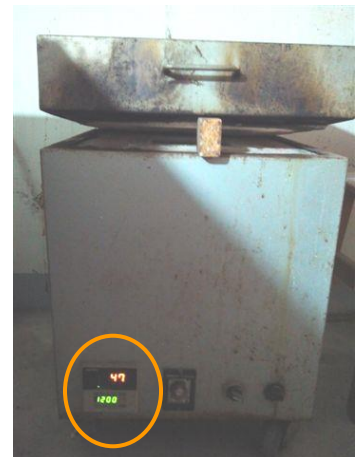
小型電窯裝置外部正視圖 設定 1200°C 需加熱 47 分鐘
