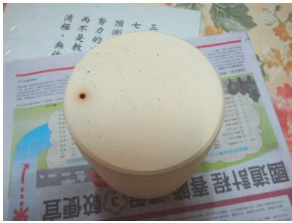
10cm 段的褐色低溫炭化桂竹
