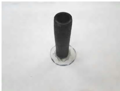
5 將炭化後的桂竹黏在刮除光碟膜的塑膠板上
