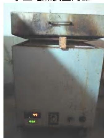
小型電窯裝置外部正視圖 設定 1200℃需加熱 47 分鐘
