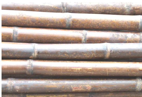
低溫炭化後的桂竹材呈茶褐色
