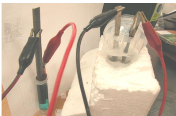
以注射針筒電鍍槽電鍍銅(正極銅箔、負極碳棒) 第三代廢鋁鐵電池可同時電解水及電鍍銅
