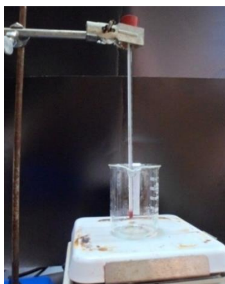
圖二、加熱澱粉測量高度的裝置圖
