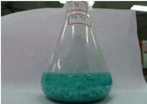
圖十五、7g 蛋殼粉靜置 7 日後銅離子去除情況
