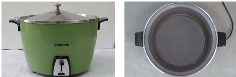
圖 31 應用 15 度的圓錐蓋子有防止滴水之效果（電鍋）
