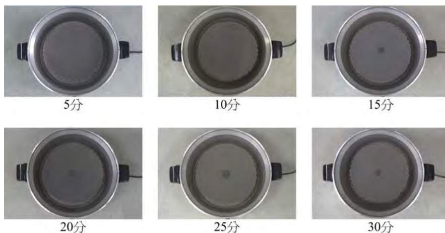
圖 14 不同偵測滴水時間對滴水痕跡之影響（電鍋）
