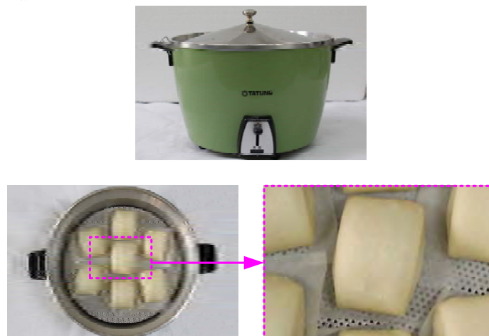
圖 33 應用圓錐蓋子的電鍋所蒸出的饅頭完全沒有滴水之痕跡
