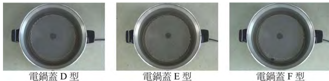
圖 22 三種電鍋蓋子滴水之情形
