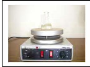
利用電動攪拌器及磁石進行攪拌
