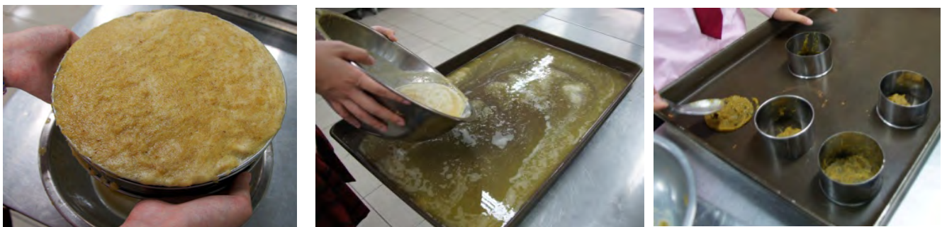
圖五、傳統抄紙法(左圖)、傾注成型法(中圖)、塗抹成型法(右圖)
