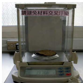
圖七、以電子秤測定果皮紙示意圖
