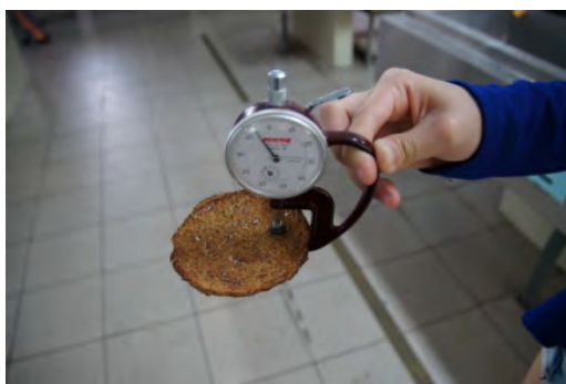
圖六、以厚度計測定果皮紙示意圖
