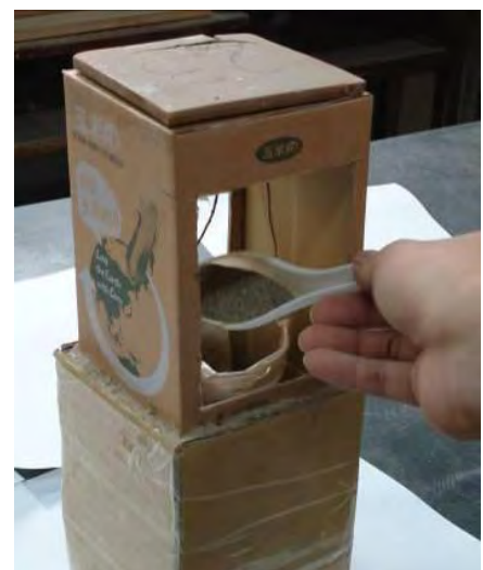
圖 5-4 以自製磁力測試台測試磁磚磁力
