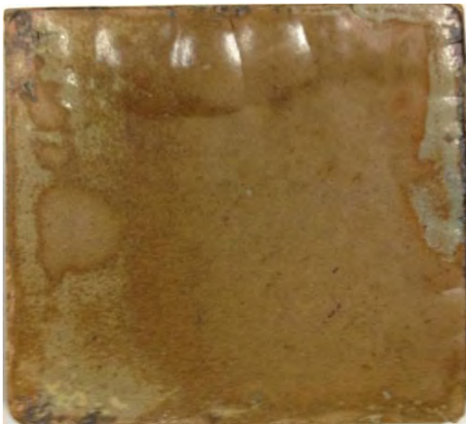
圖 5-1 釉燒 1220°C 之磁磚表面出現膨脹現象
