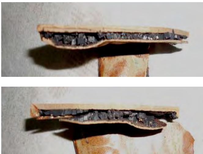
圖 5-3 磁磚之金屬層斷面呈現波浪狀
