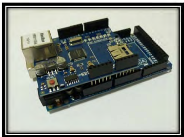
圖四 Ethernet Shield 堆疊在 Mega 2560 上
