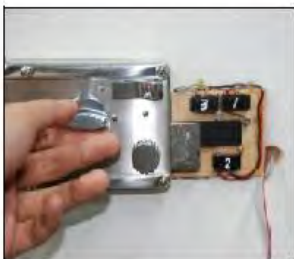
圖 56 安裝微動開關
