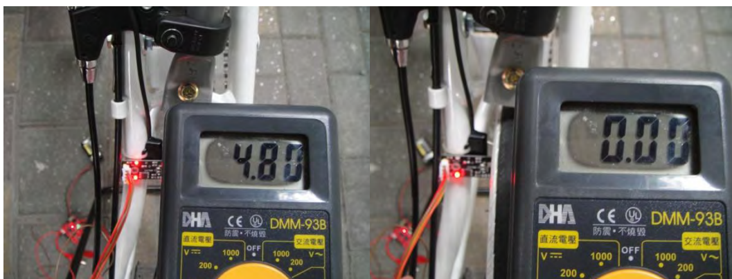
圖 16 霍爾 IC 感應測試
