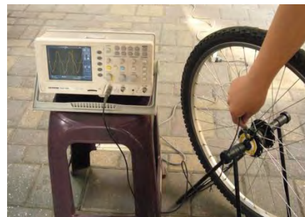
圖 4 發電花鼓發電未整流前的波形
