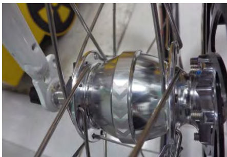
圖 3 前輪軸花鼓發電機
