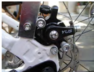
圖 18 剎車機構未作動
