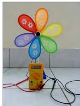
※利用小馬達搭配風車製作小型風力發電機，再將馬達連接數位式電錶測量電壓。
