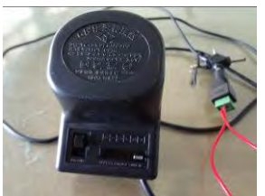
圖 31：便宜的「直流電源轉接器」（170 元），但因電壓不穩，淘汰使用
