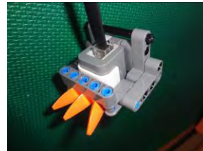
圖 25：為了固定光感，加裝電子樂高零件
