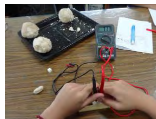
圖 63：使用三用電表檢測不同筋度電阻高低
