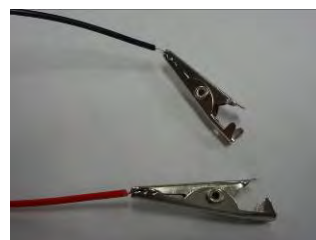
圖 126：夾子夾住 9v 電池扣電線，使用容易方便，小朋友都會使用
