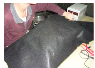
圖 64：使用光感暗箱檢測不同筋度 LED 燈亮度
