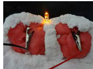
圖 139：LED 燈塞入作品的內部構造，白色為高電阻黏土，紅色為高導電黏土
