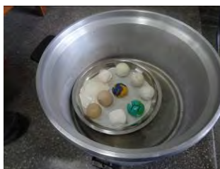
圖 41：將硬化黏土放電鍋蒸，看能否變回原狀
