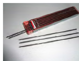
圖 143：使用 2mm 2B 工程筆筆芯導電效果最佳
