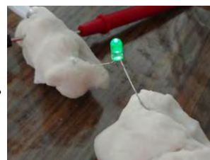
圖 151：完成的鹽黏土能讓 LED 燈發光
