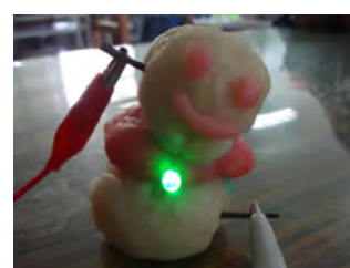
圖 147：使用工程筆芯、高導電黏土與非食用高電阻黏土製作發光作品！作品不會生鏽變色！
