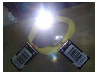
圖 118：串聯兩顆 9v 電池，LED 燈發出超亮光
