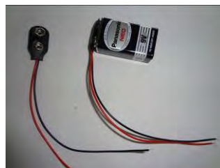
圖 105：電子材料行買到的 9v 電池扣 (一只 3 元)
