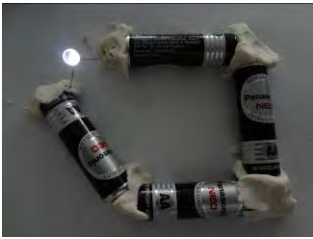
圖 116：串聯四顆 1.5v 電池，讓 LED 燈發亮
