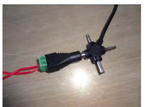
圖 32：直流電源轉接器燒毀很多 LED 燈，才發現是電壓不穩
