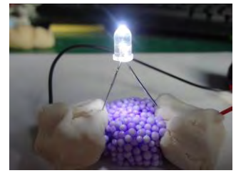
圖 46：泡泡土搭配捏麵人，LED 燈發光效果好
