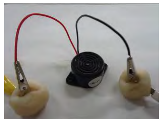
圖 111：接線式蜂鳴器需搭配鱷魚夾使用 (1 顆 30 元)
