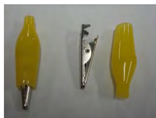
圖 125：購買鱷魚夾的夾子（一只 2 元，左側），將外層剝掉（右側）
