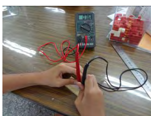
圖 37：檢測各種市售黏土的電阻大小
