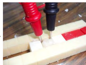
圖 13：將三用電表正負極插在黏土兩側頂點
