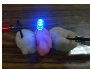
圖 146：非食用高電阻黏土(紅色)搭配工程筆芯，因電阻高，發光效果好
