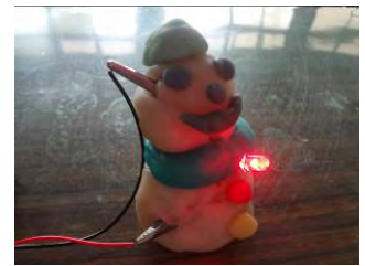
圖 107：使用鱷魚夾能大面積接觸黏土，增加導電效果，埋越深效果越好
