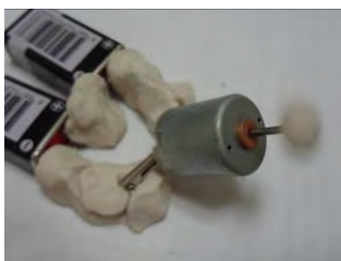
圖 108：12v 40mA 低電流馬達效果佳，馬達大顆操作方便
